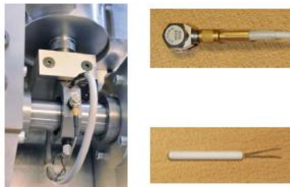
Εικόνα 14 Μέρος μέτρησης: επιταχυνσιόμετρα και αισθητήρας θερμοκρασίας
