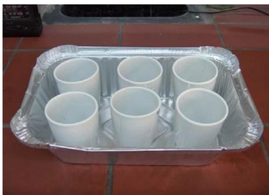
Εικόνα 6.3.α χωνευτήρια πορσελάνης Εικόνα 6.3.β : Ξηραντήριο με αφυγαντικό μέσο
