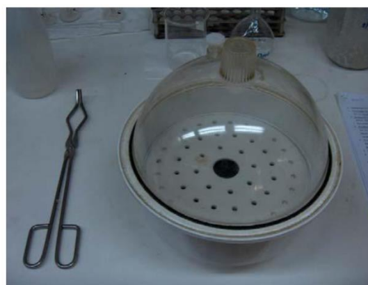
Εικόνα 6.3.α χωνευτήρια πορσελάνης Εικόνα 6.3.β : Ξηραντήριο με αφυγαντικό μέσο
