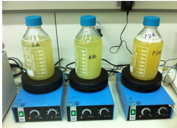
Εικόνα 3.7. Αναδευση των υγρών θρεπτικών διαλυμάτων NA, SA και PDA στις ογκομετρικές τους φιάλες πάνω σε μαγνητικούς αναδευτήρες
