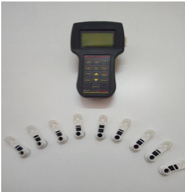
Εικόνα 28: Εξειδικευμένο όργανο OPTI-SCIENCES Chlorophyll Fluorometer OS-30p για μέτρηση δεικτών φθορισμού.
