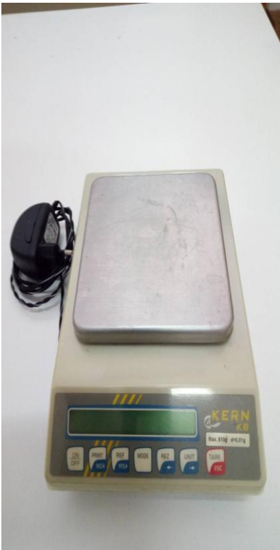
Εικόνα 23: Ζυγός ακριβείας δύο δεκαδικών ψηφίων τύπου KERN KB .
