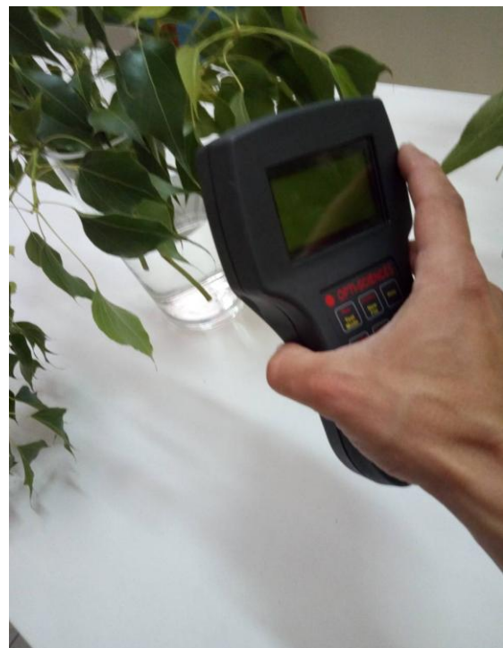
Εικόνα 31: Η στιγμή της έκθεσης του φύλλου σε ακτινοβολία μήκους κύματος 650 nm και η λήψη των τιμών – δεικτών φθορισμού.
