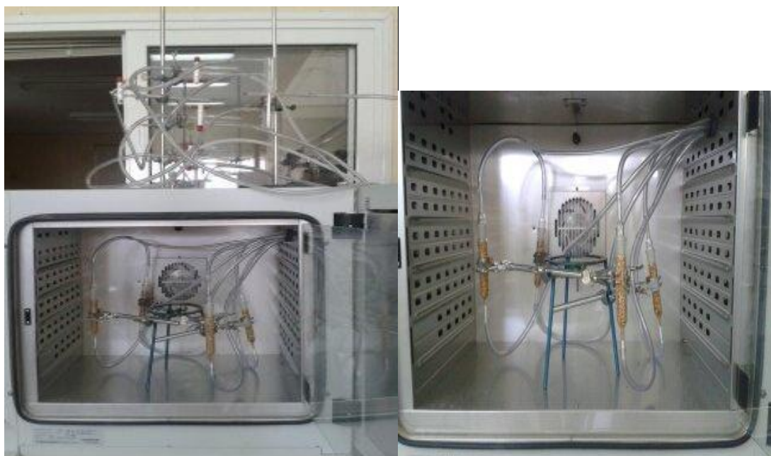
Εικόνα 2.3.2.γ. Η πειραματική διάταξη του οζονισμού των επιμολυσμένων σιταριών με αφλατοξίνες.
