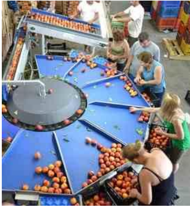
Εικόνα 7: Γραμμή ταξινόμησης-τυποποίησης εσπεριδοειδών δυναμικότητας 3-4 τόνους/ώρα (Πηγή: www.olympias.gr )
