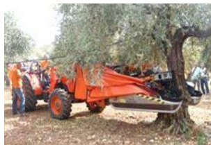
Εικόνα 1.9 : Συλλογή ελιάς με δόνηση 'Αρπαγής' του ελαιοδέντρου
