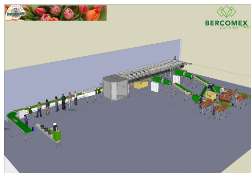
Εικόνα 100: στάνταρ ρομποτικό σύστημα Bercomex Furora, με τροφοδοσία από κιβώτια (Διαδίκτυο 100)
